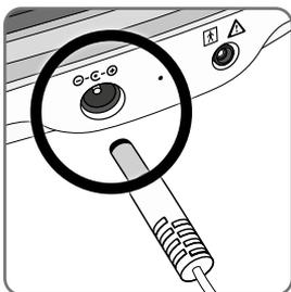
Stecken Sie den kleinen Stecker des Netzkabels in den Netzteilanschluss an der Seite des Revitive.
